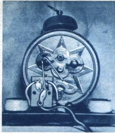
Links: Die Gesamtanordnung. Unten der Schalter, der vom Weckeraufzug aus über eine Gabel in Tätigkeit ge'etzt wi d. Oben: Die Klemme zur Befestigung der Gabel, darunter: Die einfache Schaltung der Schaltuhr. Aufnahme vom Verfasser.
